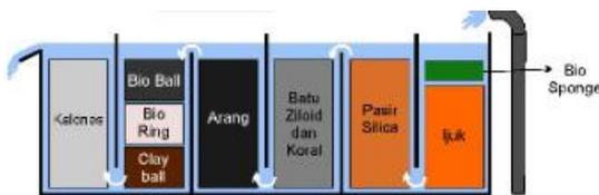
Gambar 4 adalah gambar detail dari filter. (Dokumentasi Pribadi)
