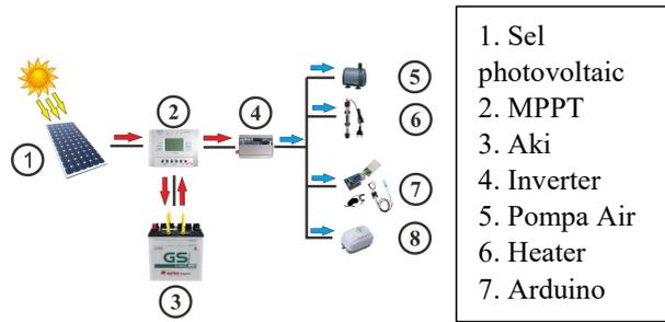
Gambar 2 adalah cara kerja aliran listrik dari sumber ke komponen-komponen. (Dokumentasi Pribadi)
